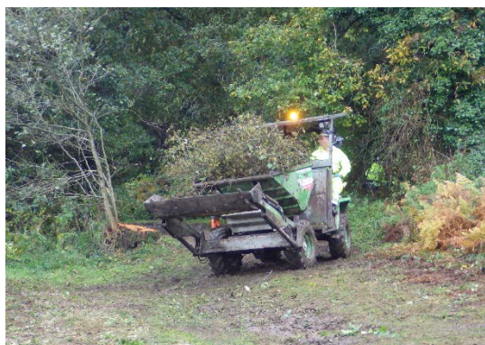
Figura 5.5.4. Empleo de chimpín para la retirada de madera generada por el apeo de pies afectados por Phytophthora spp., y posterior restauración de las sendas fluviales por las que ha transitado.
