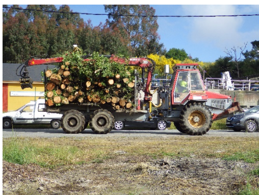
Figura 5.5.5. Empleo de autocargador operando desde una vía para la retirada de madera generada por el apeo de pies afectados por Phytophthora spp.
